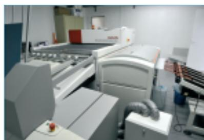
1- Machine servant à l'impression des fichiers sur la plaque offset (aluminium)
