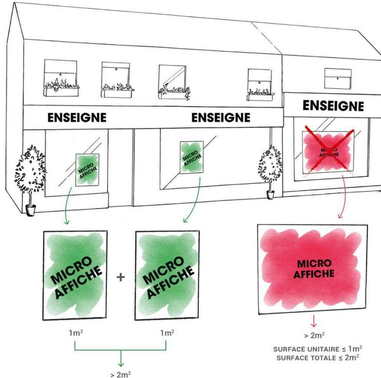
D'autres règles de la publicité sur mur ou sur clôture s'appliquent aux dispositifs de petits formats intégrés à des devantures commerciales notamment le fait qu'ils doivent être installés à plus de 50 cm du niveau du sol.
